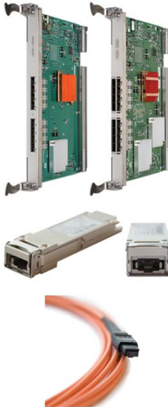
Рис. 4. Коммутационные лезвия CR16-4 и CR16-8, оптические модули QSFP и кабель с MPO разъемом.
