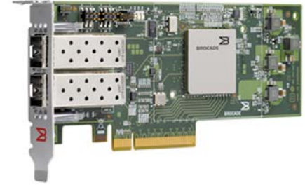
Рис. 8. Серверный адаптер Brocade 1860 Fabric Adapter.
